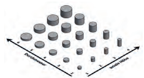
ABBILDUNG 1: MODELLE DER PROBEKÖRPER FÜR RÖNTGEN- UND METALLDETEKTORPRÜFUNG. UNTERSCHIEDLICHE KOMBINATIONEN AUS DURCHMESSER- UND HÖHENABMESSUNGEN (IN MM).
